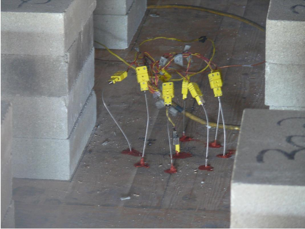
**Figure A-7. Embedded Thermocouples.**
