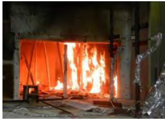
(d) exposed W1 at 85 min before 1 st ply falling off
